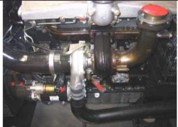
Рис.2 Выхлопная система и внешняя поверхность двигателя
