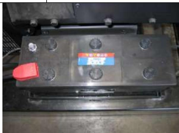
Рис.6 Аккумуляторная батарея без защитного кожуха
