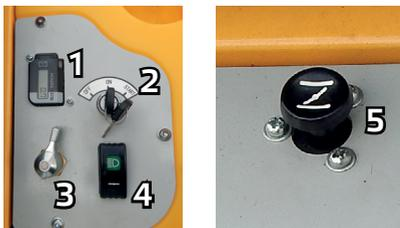
**!** **Единовременное использование электрического стартера в течение более 5 секунд приведёт к перегреву привода стартера и может вызвать неисправность стартера.**
