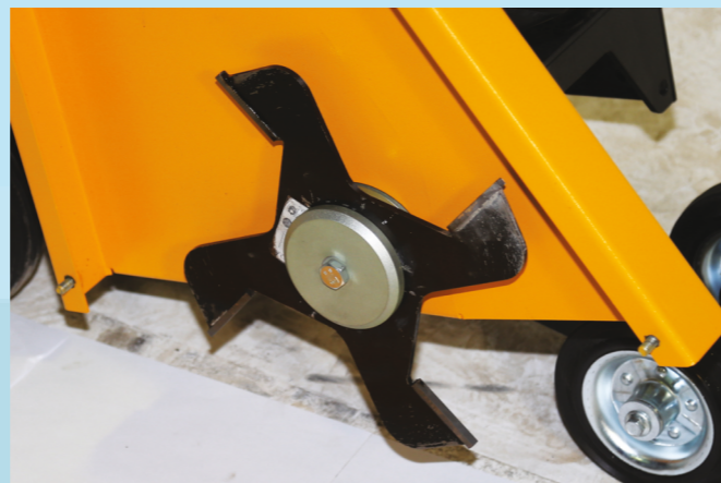
Обратное вращение инструмента способствует эффективному удалению шлама.
