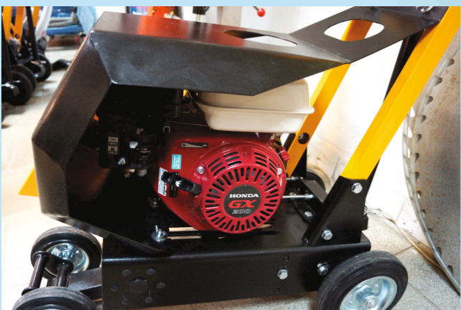
Защитный кожух надёжно предохраняет двигатель от шлама.
