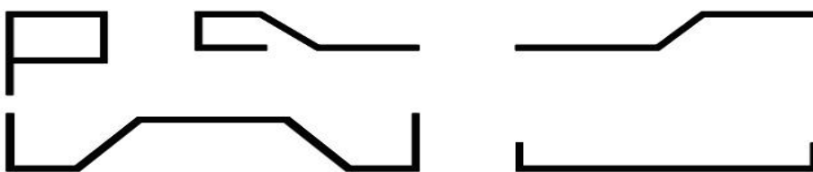
Рис. 5 Формы изгиба арматуры
