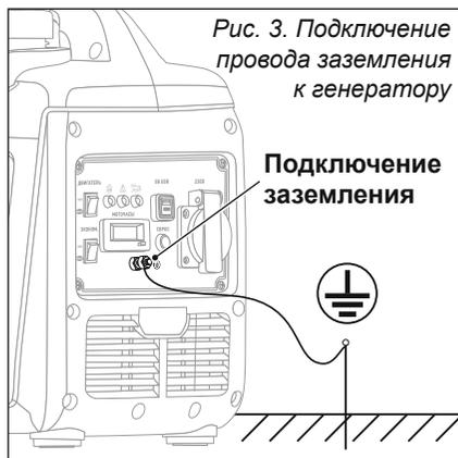
Рис. 3. Подключение провода заземления к генератору
