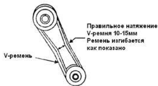
Рис. 2 Натяжение V-ремня
