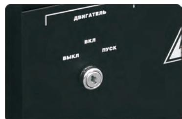
(c) Установите выключатель в положение «ВЫКЛ».
