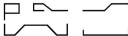
Рис. 5 Формы изгиба арматуры
