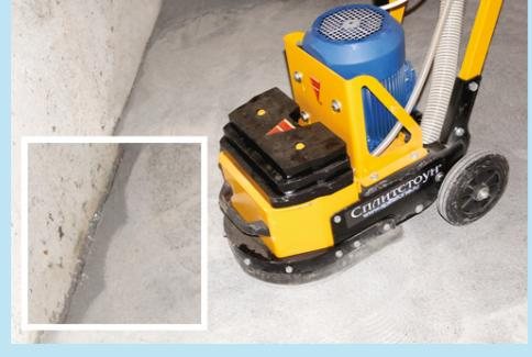
**Отсутствие "мёртвых зон"** при обработке. Минимальная необработанная зона составляет всего 1,5 см вдоль вертикального препятствия (стены, бордюра и т.д.)
