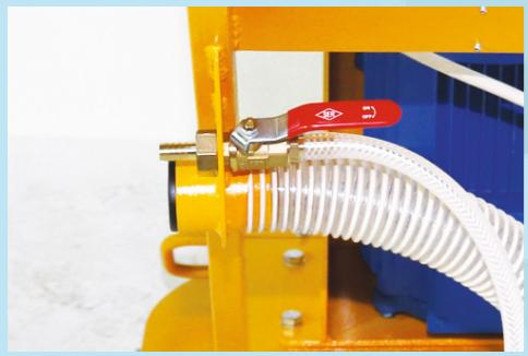
**Возможность подключения пылесоса,** для которого установлен переходник диаметром 50 мм. Предусмотрена возможность подачи воды в зону обработки через полый вал.
