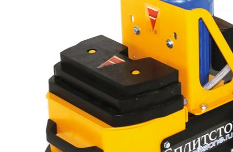
**Использование дополнительного груза.** Для высокой производительности необходимо создать сильное давление алмазного инструмента на обрабатываемую поверхность. Для этой цели машины комплектуются дополнительными съёмными грузами.
