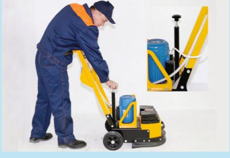
**Регулировка подъёма колёс.** Полировальный абразивный инструмент отличается значительной высотой полировальных элементов. Для сохранения работоспособности траверсы в горизонтальном положении предусмотрена юстировка колёс по высоте (износу) инструмента при помощи специального винта.
