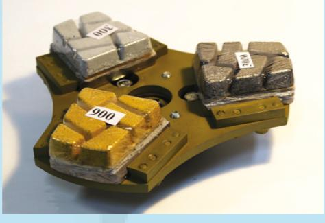
**Возможность установки абразивных полировальных инструментов.** На наших машинах предусмотрена возможность проведения различных технологических операций от грубой, черновой шлифовки поверхности до установки абразивных полировальных инструментов.
