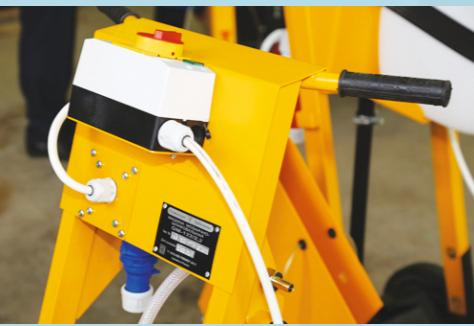
**Оснащение электрических цепей машин защитой** по тепловой нагрузке, току утечки и от короткого замыкания. Уровень защиты IP54 — традиционный класс для водозащищённого исполнения.
