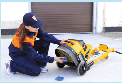
**Быстрая и удобная замена режущего инструмента - франкфуртов.** В отличие от машин других производителей наш инструмент крепится на траверсу путём вставки в специальные пазы без использования дополнительных крепёжных элементов.
