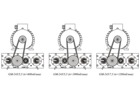
**Многоскоростной режим вращения траверс.** На мозаично-шлифовальных машинах GM-245 (5.5) имеется возможность изменения частоты вращения с 600 об./мин на 1000 об./мин, и наоборот за счёт перестановки шкива с одного вала на другой.
